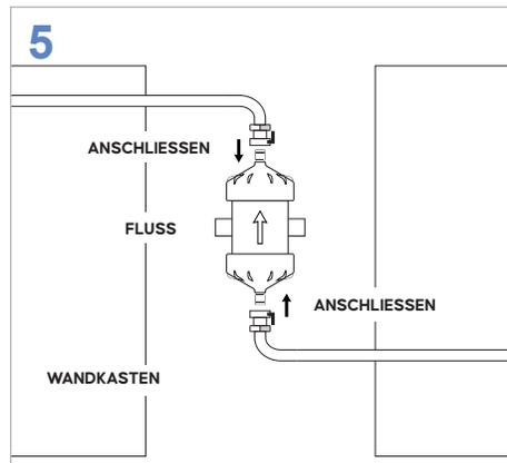
**5** DRÜCKEN Sie den Filter in den C-Clip, so dass die Flussrichtung in Richtung Wandkasten geht.
